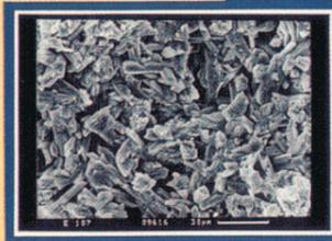
Die Unterschiede zeigen sich im verschiedenartigen Aufbau der Kristallite. - Weniger Wasser begünstigt den plättchenhaften Aufbau der Kristallite.
