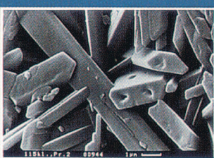
Modelloberfläche ohne Spuren von Stellmitteln
