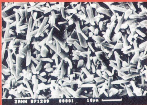
Die unbehandelte Oberfläche der Gipsprobe (Velmix Stone) zeigt Kristallnadeln in unterschiedlicher Anordnung mit dazwischenliegenden Porenräumen. **Es handelt sich also bei Gipsoberflächen nicht um homogene und dichte Strukturen.** Die Versiegelung der Gipsoberfläche mit einem Lack verfolgt die Absicht die Poren zu verschließen und die Kristallnadeln zu schützen.
