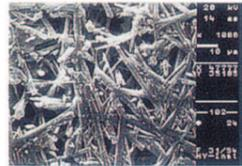
Abbildung 2: Gips auf Polyethylenfolie abgebunden
