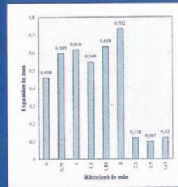
Nebenstehende Abbildung (links) zeigt die Abbindeexpansion des Dentalgipses Ludur G in Abhängigkeit von der Rüttelzeit t<sub>R</sub>. Es werden verschiedene Chargen verglichen. A1 nimmt mit der Rüttelzeit ab. Die Übereinstimmung unter den Chargen ist befriedigend.
