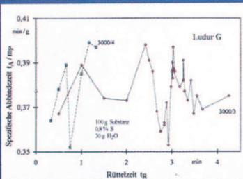
Spezifische Abbindezeiten versus Rüttelzeit für unterschiedliche Erregung des Rüttlers. Angaben: Frequenz/Amplitude in Schw./min und w/E.
