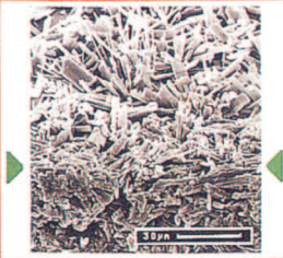
REM-Foto einer ausgeblühten Modellgips-Oberfläche. Die Markierungen weisen auf die Bruchkante. Die Oberfläche ist nach vorne geneigt.
