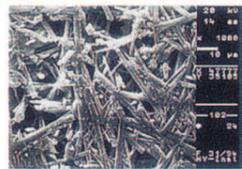
Abbildung 2: Gips auf Polyethylenfolie abgebunden
