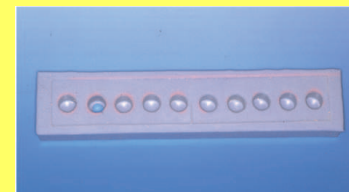
Abb.2 Silikonform zur Herstellung der Gipsprüfkörper
