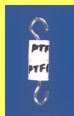
Abb.5 Gipskörperpaar mit Abzugshaken
