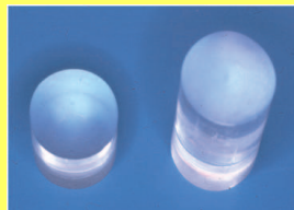
Abb.1 Plexiglaszylinder zur Herstellung der Silikonformen Zylinder links im Bild: h = 10 \text{ mm} d = 10 \text{ mm} Zylinder rechts im Bild: h = 20 \text{ mm} d = 10 \text{ mm}
