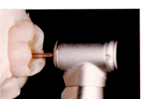
Fräsen der Kavität: Beim derzeitigen Entwicklungsstand mit nur zwei Achsen werden zylindrische Schleifkörper eingesetzt. D.h. das Inlay hat in vertikaler Dimension den gleichen Querschnitt.
