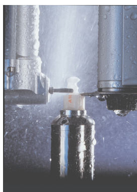
Abb.4: Cerec-System, Herausfräsen eines Inlay aus einem Keramikblock
