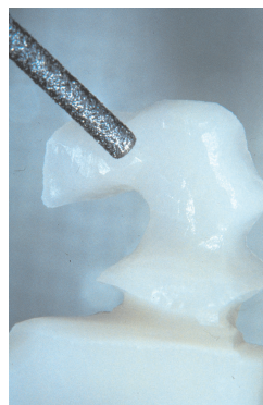
Abb.9: Celay-System, Fräsen der feineren Konturen mit diamantierten Schleifkörpern
