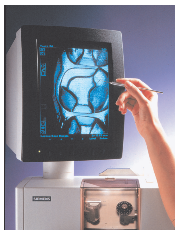
Abb.3: Cerec-System, Darstellung der Kavität auf dem Monitor
