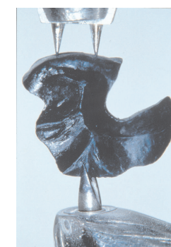
Abb.7: Celay-System, Abstastnadel der Kopierschleifeinrichtung am Proinlay
