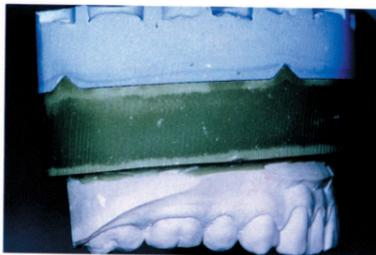
Bei Tests mit Gipsen unterschiedlicher Expansion war kein Zusammenhang zwischen der Höhe der im Gips gemessenen Expansion und des daraus entstandenen Spaltes festzustellen. Zudem entstand der Spalt nicht, wenn mit gleicher Vorgehensweise der Splitcast ohne Magnet, Magnettopf und Haftscheibe angefertigt wurde. Hieraus läßt sich schließen, daß die Abbindeexpansion nicht als Ursache für die Spaltbildung im Splitcast anzusehen ist.
