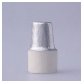
Abb.5: Stumpf nach Auftragen eines Leitsilberlackes
