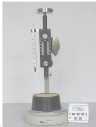
Die **lineare Abbindeexpansion** wird mittels eines Extensometers gemessen. Es besteht aus einem Trog, der an einer Seite mit einer beweglichen Anschlagplatte versehen ist, die in Verbindung zu einem Meßfühler steht.
