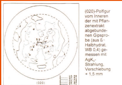
(020)-Polfigur vom Inneren der mit Pflanzenextrakt abgebundenen Gipsprobe (aus \beta -Halbhydrat, WB 0,4) gemessen mit AgK \alpha -Strahlung, Verschiebung + 2,5 mm
