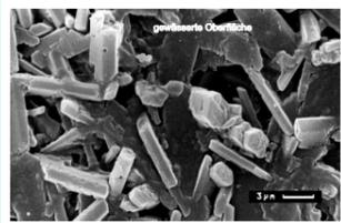
Langzeit-Wässerung in gesättigtem Wasser bedeutet für die Oberfläche: **Abtrag und Aufbau von Kristallen.**
