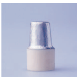
Abb.5: Stumpf nach Auftrag eines Leitsilberlackes
