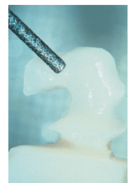
Abb.9: Celay-System, Fräsen der feineren Konturen mit diamantierten Schleifkörpern
