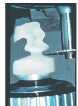
Abb.8: Celay-System, grobes Formfräsen mit diamantierten Schleifscheiben
