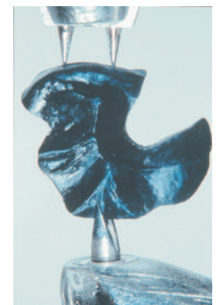
Abb.7: Celay-System, Abtastnadel der Kopierschleifeinrichtung am Proinlay
