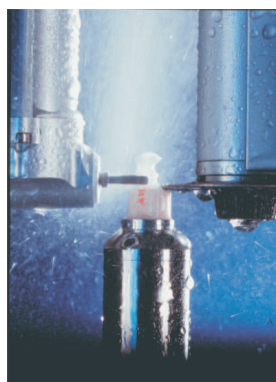
Abb.4: Cerec-System, Herausfräsen eines Inlay aus einem Keramikblock
