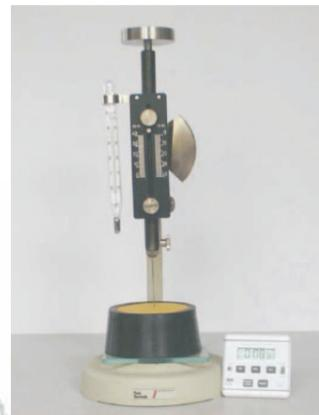
Die **lineare Abbindeexpansion** wird mittels eines Extensometers gemessen. Es besteht aus einem Trog, der an einer Seite mit einer beweglichen Anschlagplatte versehen ist, die in Verbindung zu einem Meßfühler steht.
