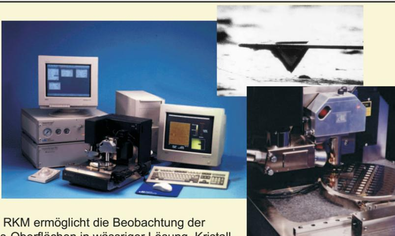
Die RKM ermöglicht die Beobachtung der Gips-Oberflächen in wässriger Lösung. Kristallwachstumsprozesse können in-situ untersucht werden. Verschiedene Wachstumsmechanismen können identifiziert und charakterisiert werden.
