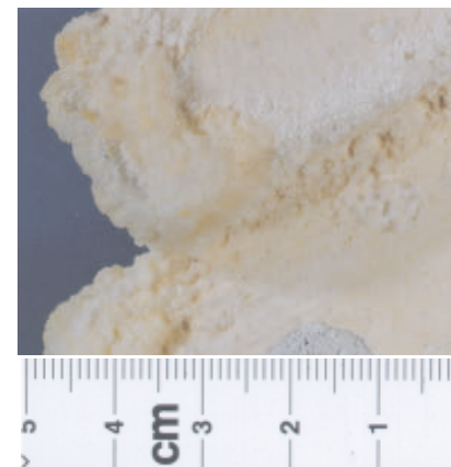
Bild 1: Magnesiumsulfat-Heptahydrat auf der Oberfläche einer Gipsplatte
