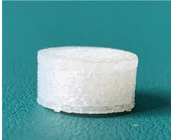
Abbildung 13: 3D-gedruckte Tablettenform aus HPC SSL (Drucktemperatur: 190 °C, Druckbetttemperatur: 70 °C, Druckgeschwindigkeit: 20 mm·s -1 , Schichtdicke: 0,13 mm, Infill: 30 %, Infilldruckgeschwindigkeit: 20 mm·s -1 ).
