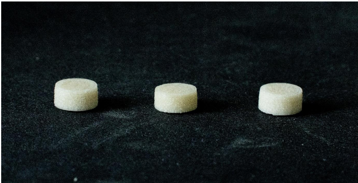
Abbildung 19: Beispielbilder von 3D-gedruckten Tabletten ( \varnothing : 10 mm, Höhe: 5 mm) bestehend aus einer ternären Mischung aus Hydroxyethylcellulose HX, Hydroxypropylcellulose SLL und Diclofenac-Natrium (F-HEC-HX). (Drucktemperatur: 195 °C, Druckbetttemperatur: 60 °C, Druckgeschwindigkeit: 35 \text{ mm} \cdot \text{s}^{-1} , Schichtdicke: 0,3 mm).
