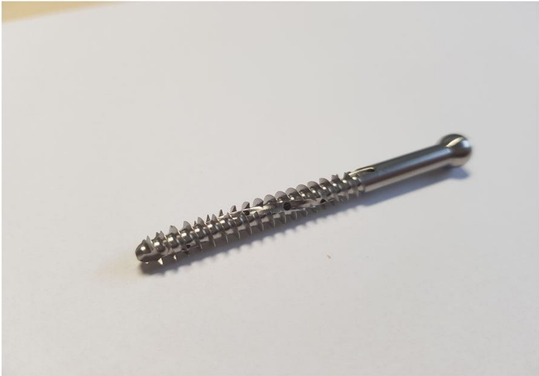
Abbildung 14: Zementaugmentierbare Schraube. Kanülierte, zementaugmentierbare Schraube der Firma Zimmer Biomet mit einem Durchmesser von 5 mm. Zwei Längsfurchen mit jeweils zehn Perforationslöchern sorgten entlang der Schraubenwelle für eine optimale Zementextrusion.
