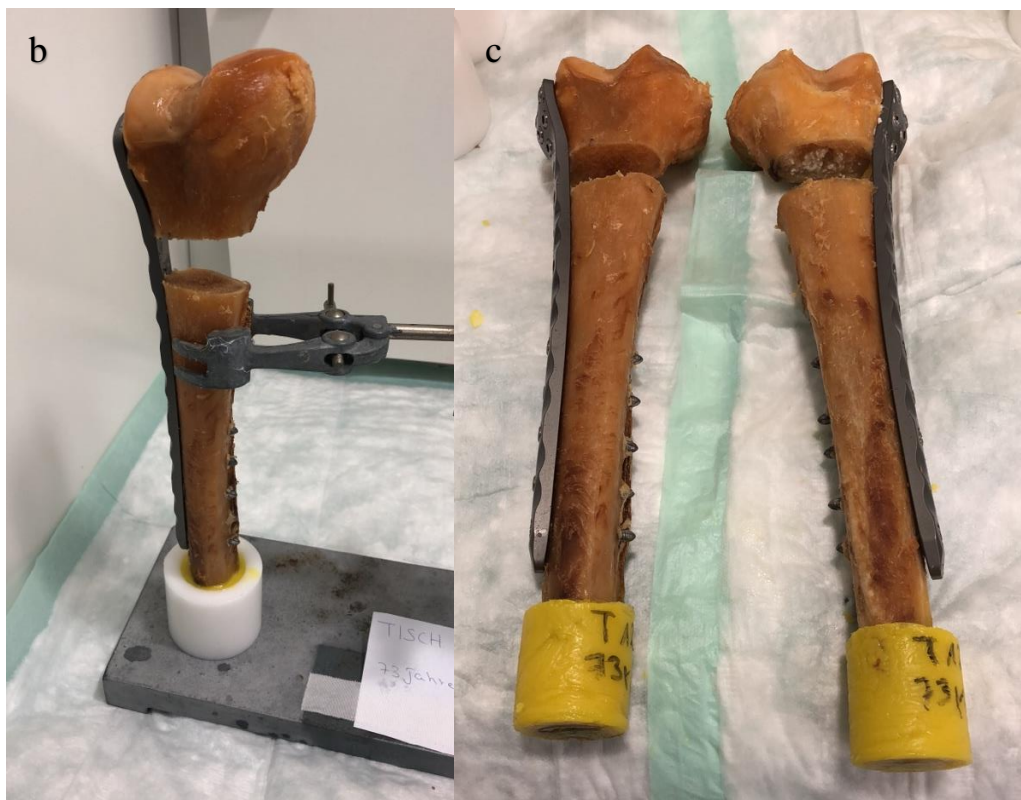
Abbildung 18: Einbettung des Femurschaftes. a) Positionierung der Femora in Zylinderformen. b) Eingießen von Technovit 3040. c) Fertiger Standfuß nach Aushärtung.
