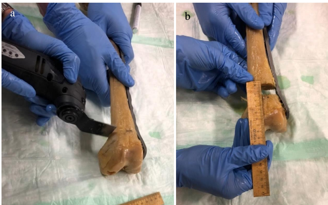
Abbildung 12: Osteotomie und Frakturmodell. Dargestellt ist nach bereits angebrachter Osteosynthese die Osteotomie (a) sowie das Frakturmodell des Typs 33-A3 mit einem Frakturspalt von 2 cm (b) an einem linken Femur.
