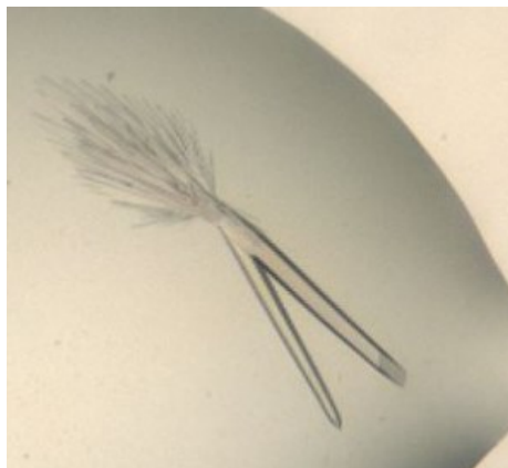
Abbildung 31: Kristalle des TGT-Heterodimers bei folgender Zusammensetzung der Kristallisationslösung: 100 mM Natriumcitrat pH 5,6, 500 mM (\text{NH}_4)_2\text{SO}_4 , 1 M \text{Li}_2\text{SO}_4 .
