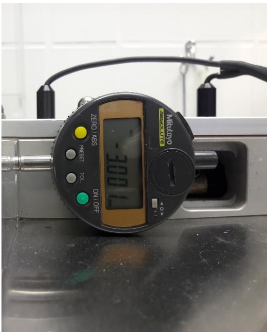
Abb. 6: Exaktes Vermessen der Schnittstärke
