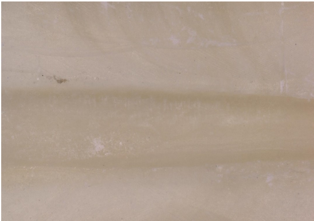
Abbildung 11: Beispielaufnahme eines Kanalabschnitts nach dem 2. Revisions-schritt und Aktivierung mit SF65 in 200x Vergrößerung
