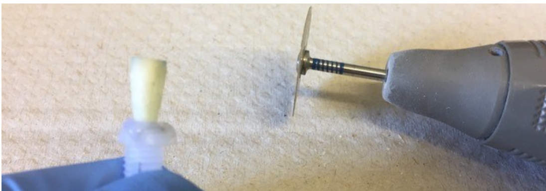
Abb. 12: Mit Heißkleber auf Kunststoff-Schraube befestigte Zahnwurzel und Handstück mit Trennscheibe.
