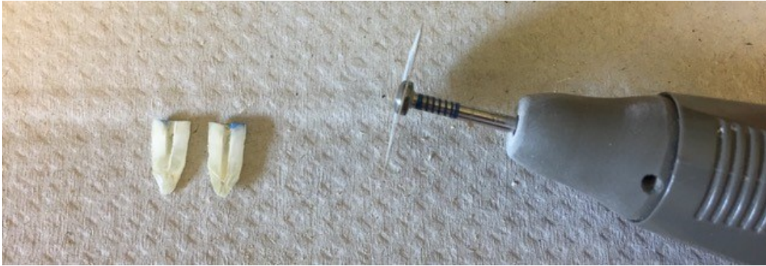
Abb. 13: Zahnwurzelhälften nach Längsschnitt mittels Trennscheibe.
