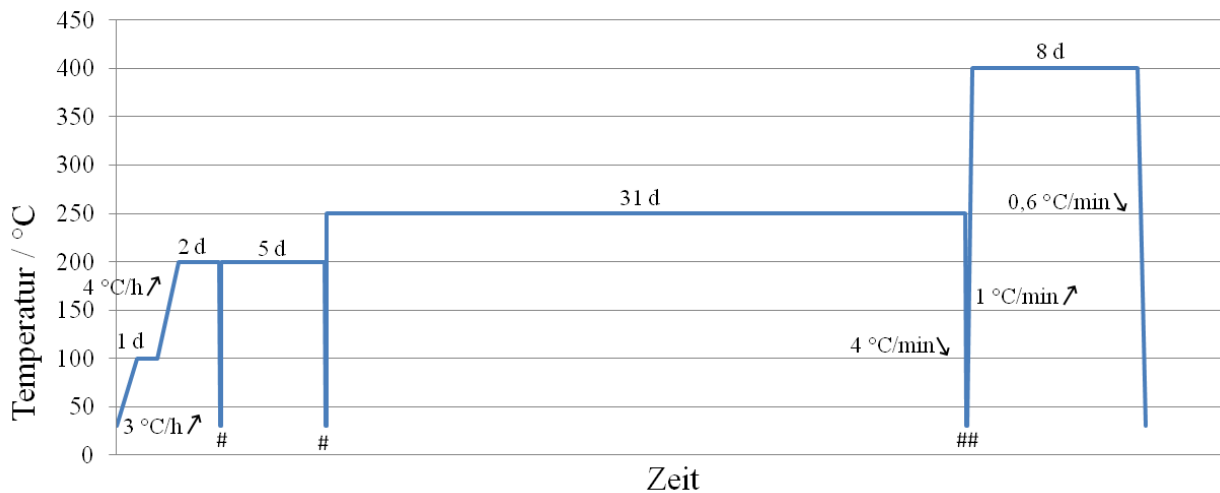
Abbildung A 22. Temperaturprofil der Syntheserversuche von \text{LiNaSiF}_6 und \text{LiRbSiF}_6 in 10 % \text{F}_2 mit einer Flussrate von 5 mL/min. Die Proben, welche sich in Stahlnetzschiffchen befanden, wurden an den mit # gekennzeichneten Punkten an Luft gemörsert. Vor und nach dem Mörsern wurden die Proben mit einer Rate von 4 °C/min aufgeheizt, beziehungsweise abgekühlt. An dem Punkt mit ## wurden die Proben ebenfalls gemörsert und in ein Korundschißchen überführt.
