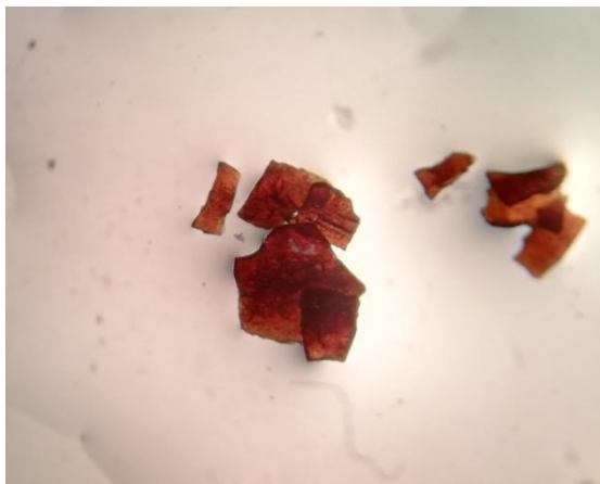
Abbildung 247. Fotografie der mehreren Millimeter großen, roten Kristalle, welche sich im Verlauf der weiteren Analytik als [\text{AgF}_2]_2[\text{PtF}_6] herausstellten. Das Foto wurde durch das Okular eines Lichtmikroskops aufgenommen.
