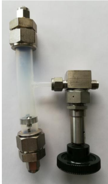
Abbildung 14. Fotografie der selbst angefertigten Transferapparatur aus FEP, um besonders luftempfindliche Proben aus den Fluorierungsöfen in den Handschuhkasten zu transferieren.
