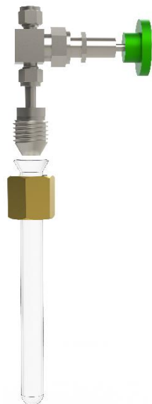
Abbildung 8. Zeichnung eines Reaktionsgefäßes für Reaktionen mit wasserfreiem HF und \text{BrF}_3 . Entnommen aus der Literatur, in welcher sich auch eine Konstruktionsskizze dieses Reaktionsgefäßes befindet. [158]
