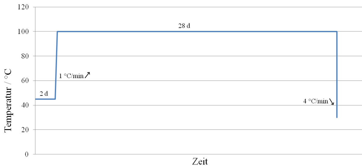
Abbildung A 12. Temperaturprofil des Syntheseversuchs von CaSiF_6 ausgehend von SiO_2 als Siliciumquelle in 100 % F_2 mit einer Flussrate von 0,5 mL/min. Die Probe befand sich in einem Korundschiffchen.
