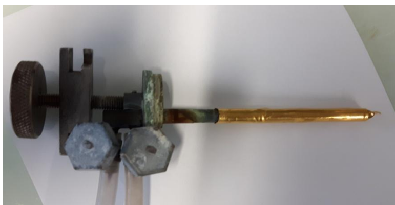
Abbildung 15. Photographie des Kühlfingers für die Fluorierungsöfen mit angeschlossenen Kühlwasserschläuchen und überzogener Goldampulle, an welcher sich das Sublimat sammelt. Eine Konstruktionsskizze dieses Kühlfingers befindet sich in der Literatur. [158]
