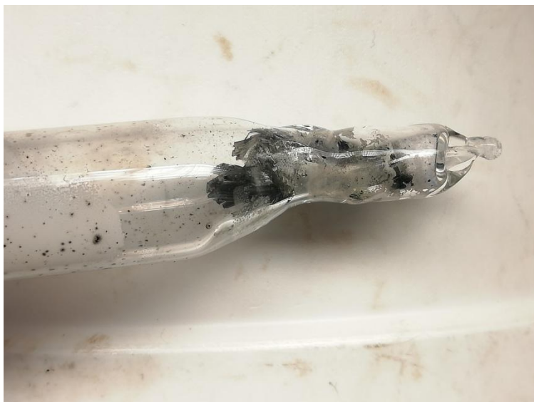
Abbildung 85. Fotografie von grauem, an die Senke transportiertem \text{CrCl}_2 in einer Glasampulle.
