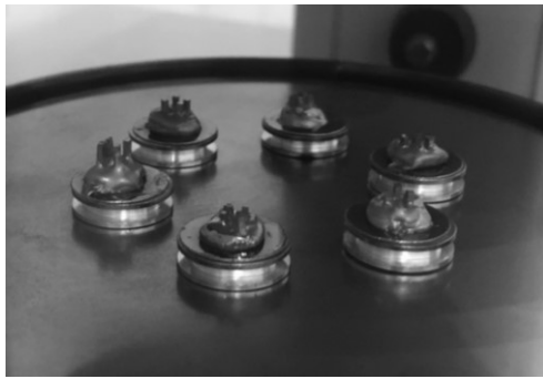
Abb.: 4.7 Die Objektträger nach dem Besputtern mit einer Gold-Palladium-Schicht
