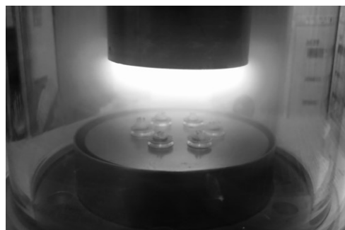
Abb.: 4.6 Der Sputter Coater beim Beschichten der Proben mit einer Gold-Palladium-Schicht
