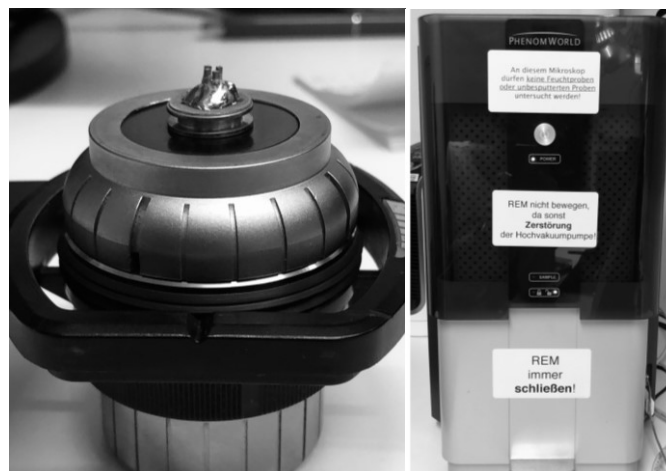
Abb.: 4.8 Probenhalter (links) und Rasterelektronenmikroskop (rechts)
