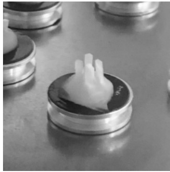
Abb.: 4.5 Vier Dentinstäbchen auf einem Aluminium-Objektträger
