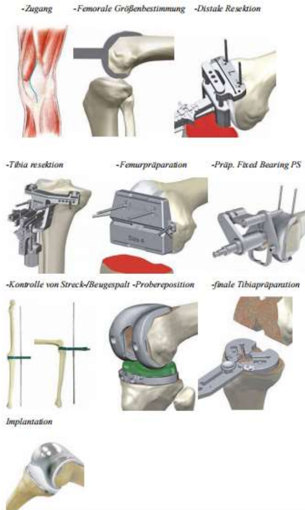
Abb. 9: Ablauf der Operation (Bilder aus Firma Waldemar Link GmbH & Co, 2017)
