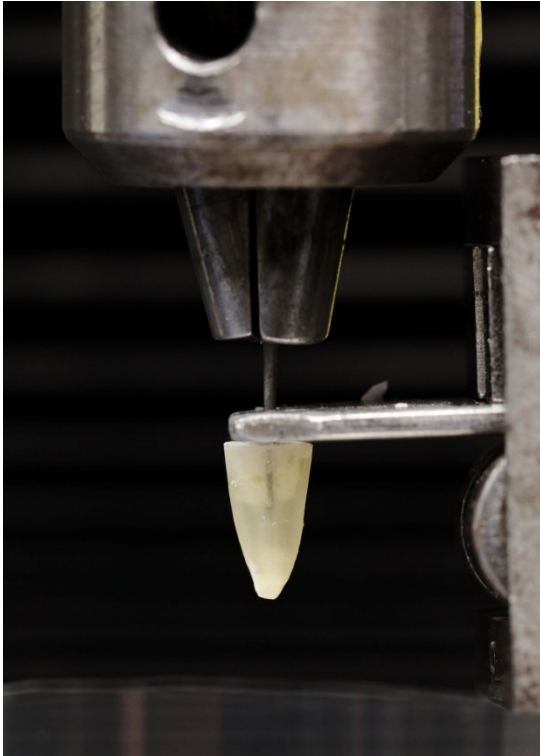
Abbildung 5: Eingespannter Probezahn in der Zwick-Universaltestmaschine
