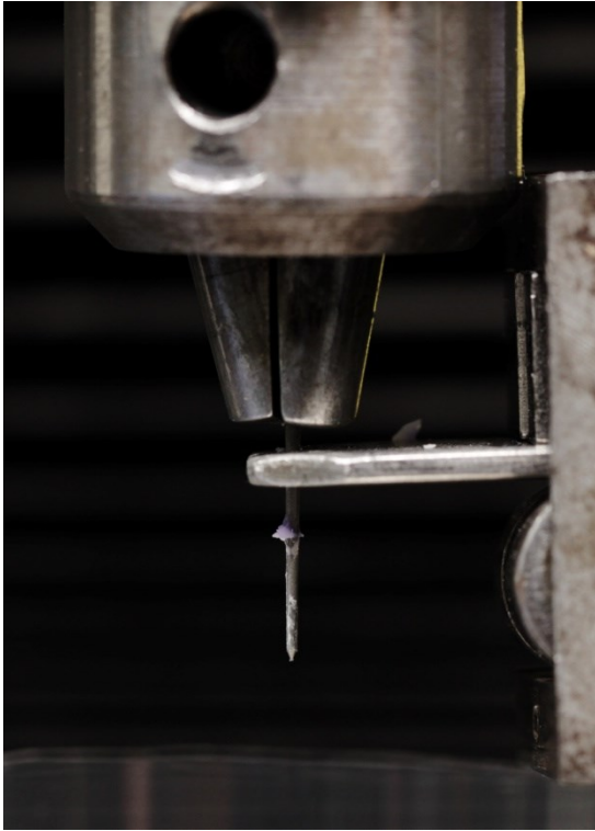
Abbildung 6: Situation nach Extrusion des Spreaders aus einem Probezahn nach Rückkehr in die Ausgangsposition
