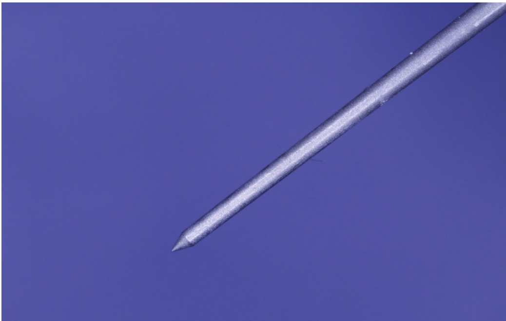
Abbildung 8: Exemplarisches Beispiel eines Spreaders nach der Pullout-Analyse mit einem adhäsiven Versagen am Stift
