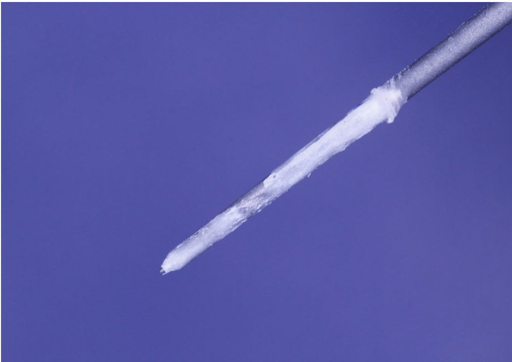
Abbildung 10: Exemplarisches Beispiel eines Spreaders nach der Pullout-Analyse mit einem adhäsiven Versagen am Dentin
