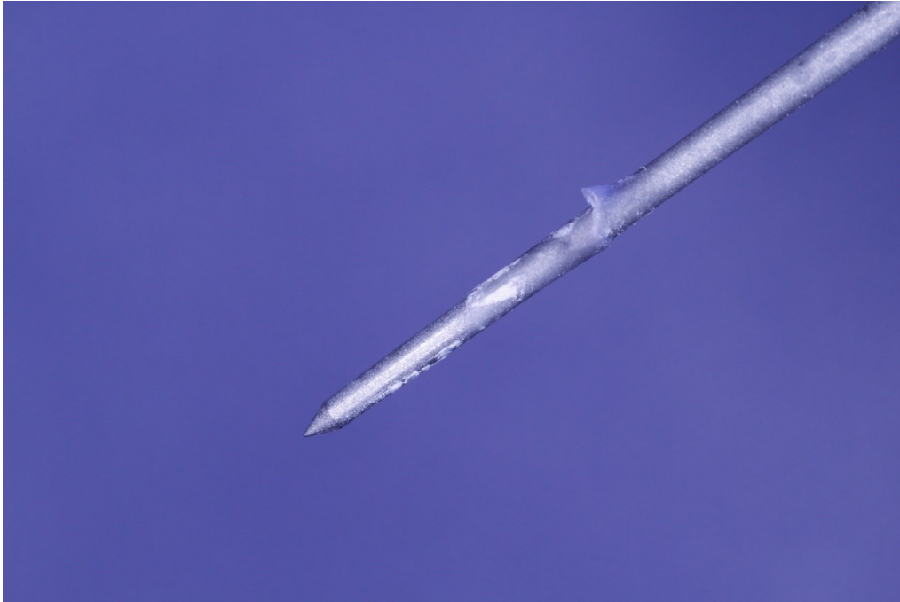
Abbildung 11: Exemplarisches Beispiel eines Spreaders nach der Pullout-Analyse mit einem gemischten Frakturmodus
