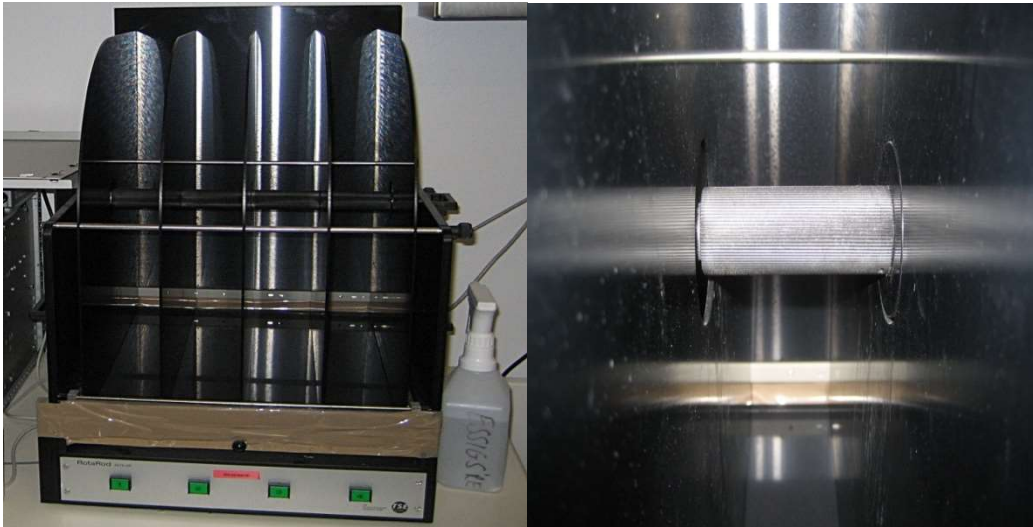
Abb. 2.1: 4-Kammer Rotarod-Apparat aus Versuchslaberperspektive (links) und Detaildarstellung einer Kammer mit Drehstab (rechtes Bild) Aufnahme im Verhaltenslabor des BMFZ der Philipps-Universität Marburg (Bildmaterial wurde auch bei der Dissertation von M. Lunow verwendet)
