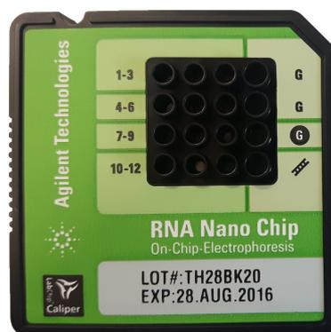
Abbildung 3: Chip für RNA- Nachweis mittels Gelelektrophorese
