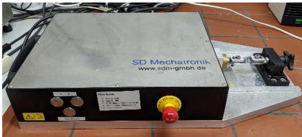
Abbildung 18: Kleinlast-Prüfmaschine (MTD-500 plus, SD Mechatronik GmbH, Feldkirchen, Deutschland).
