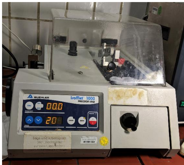
Abbildung 14: Präzisionskreissäge IsoMet® 1000 Precision Saw (Fa. Buehler, Lake Bluff, Illinois, USA).
