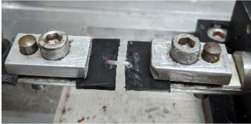
Abbildung 19: Dentin- und Kompositfragment nach Bruch.
