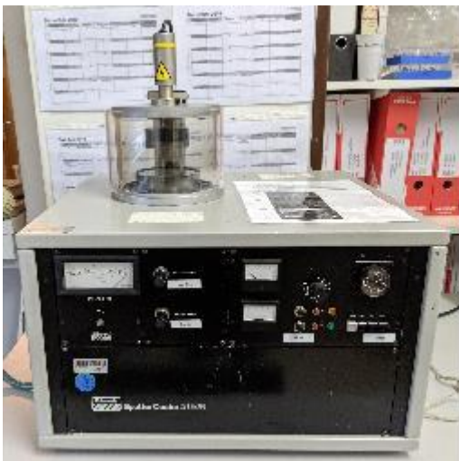
Abbildung 24: Besputtern der Dentinfragmente im Sputter Coater (D15B, Firma Edwards).
