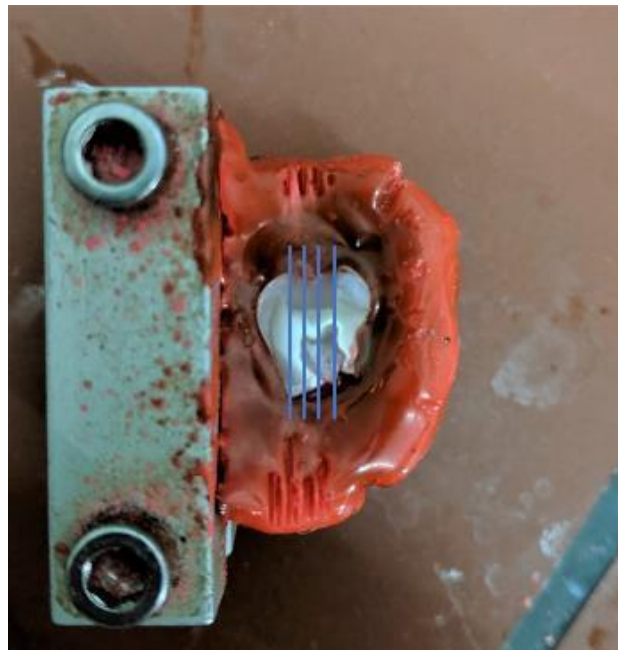
Abbildung 16: In Stäbchen gesägte Zahnscheibe.
