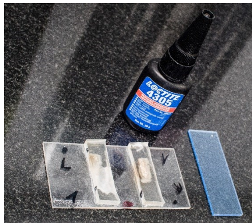
Abbildung 9: Zur Vorbereitung für Trenn-Dünnschliff-Technik Eingebettete Präparate auf Objektträger geklebt
