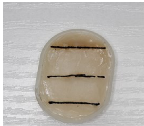
Abbildung 42: Komposit nach Kontakt: 970nm Laser 3W (oben) 455nm Laser 2W (mittig) 445nm Laser 4W (unten)
