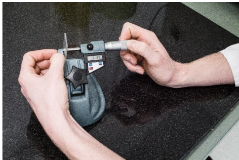
Abbildung 16: Manuelle Messung der Präparatdicke zu Kontrolle
