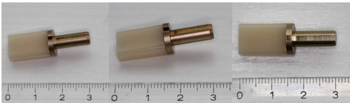
Abbildung 36: Keramik nach Kontakt mit 970nm Laser 4W
