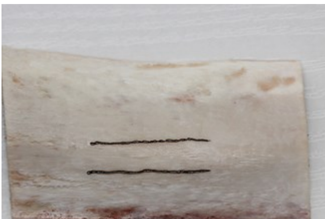
Abbildung 43: Knochen nach Kontakt 970nm Laser 3W (kein Effekt oben) 455nm Laser 2W (mittig) 445nm Laser 4W (unten)
