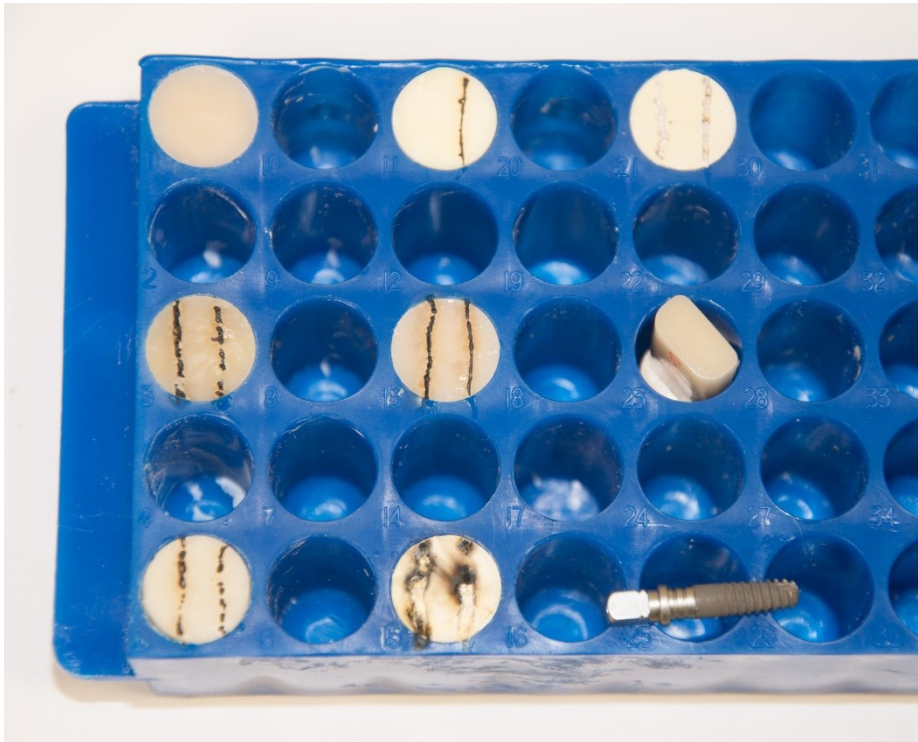
Abbildung 30: Eppendorf Gefäßständer nach Laser-Kontakt links in der Probe: Kontakt durch roten Laser, rechts in der Probe: Kontakt durch blauen Laser
