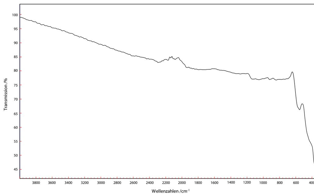
**Abbildung 4.35:** Infrarotspektrum vom Zersetzungsprodukt des  $\text{Mn}(\text{N}_3)_2(\text{NH}_3)_2$  (**6**). Messung auf einem Diamant-Kristall im ATR-Verfahren von 400 bis  $4000\text{ cm}^{-1}$  mit  $4\text{ cm}^{-1}$  Auflösung und 64 Aufnahmen.
