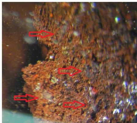
**Abbildung 8.12:** Kristalle von  $[\text{Cu}(\text{NH}_3)_2]\text{F}\cdot\text{NH}_3$  (**57**) bei Zimmertemperatur im geschlossenen Bombenrohr. Die roten Pfeile zeigen auf einige farblose Kristalle der Verbindung **57**, eingeschlossen in elementarem Kupfer.
