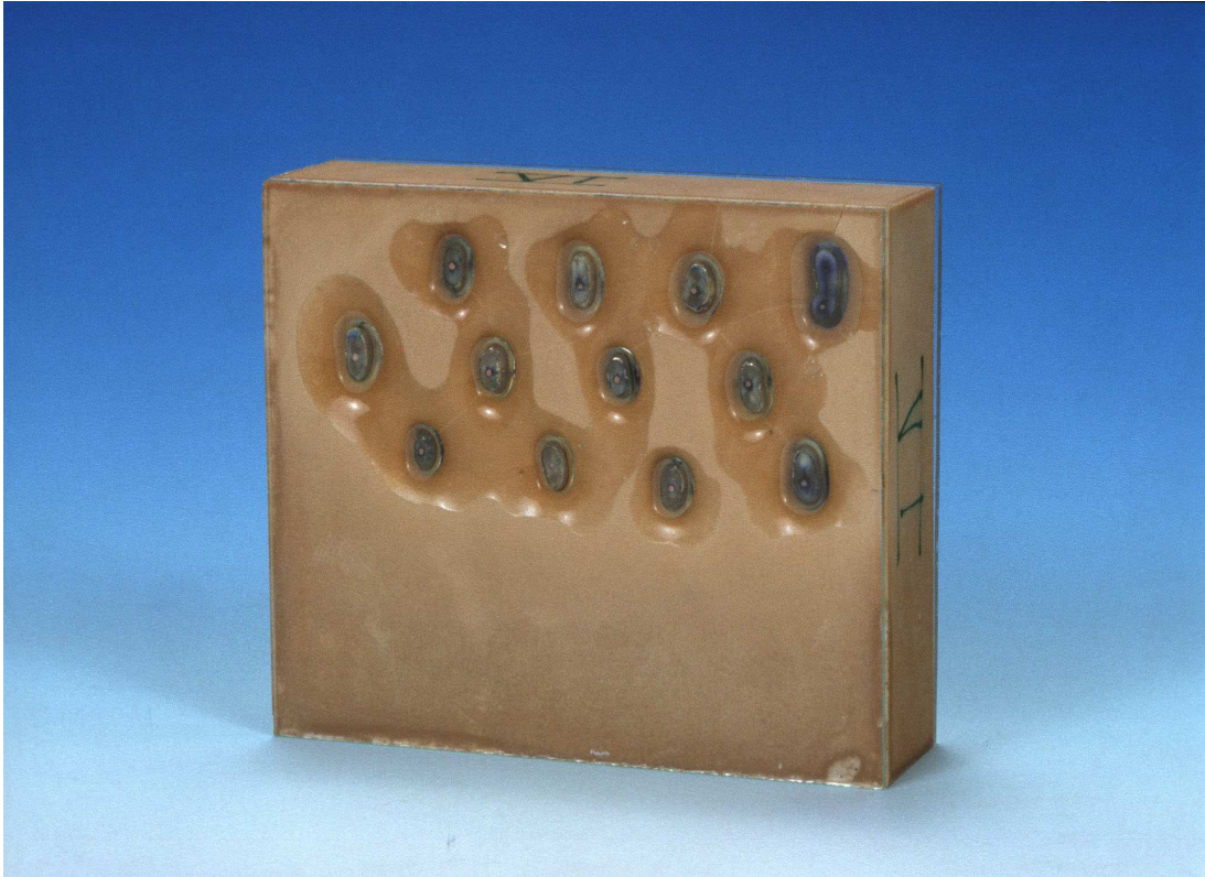
Abb.8: Epoxidharzblock mit eingebetteten Probenzähnen
