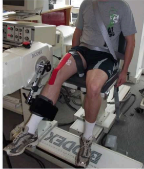
Abbildung 2.3: Darstellung des Aufbaus der Kraftmessung. Der Proband ist durch ein spezielles Gurtsystem auf dem Dynamometer fixiert. Der Oberkörper, die Taille und der rechte Oberschenkel sind am Sitz festgeschnallt, während das rechte Bein auf Höhe des distalen Unterschenkels über eine gepolsterte Manschette an dem Hebelarm des Dynamometers befestigt ist. Dieser registriert das Drehmoment bei maximaler Extension im Kniegelenk.
