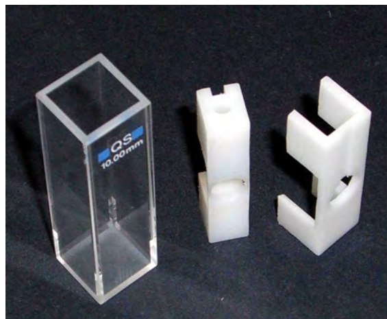
Abbildung 150. Zweiteilige Linsenhalterung aus Polyoxymethylen und 4-Fenster Quarzglasküvette.
