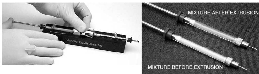
Abb. 2.47: Avanti Polar Lipids® Mini-Extruder (links); die Liposomendispersion vor und nach dem Extrudieren (rechts).
