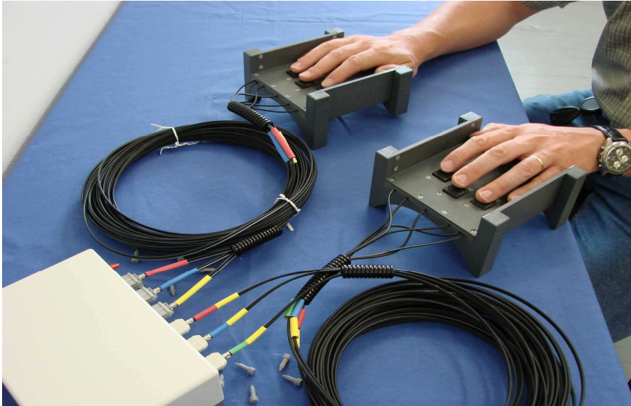
Abbildung 8: Antwortkonsole mit Konverter: Die Antwortkonsole bietet jeweils drei Antwortknöpfe pro Hand und ist mit einem Konverter verkabelt.
