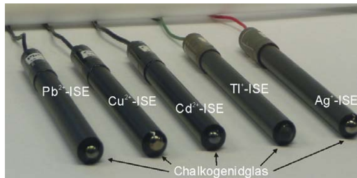
Abb. 1.2: Foto von konventionellen Chalkogenidglas-ISEs für die Erfassung von \text{Pb}^{2+} -, \text{Cu}^{2+} -, \text{Cd}^{2+} -, \text{TI}^+ - und \text{Ag}^+ -Ionen in Flüssigkeiten.
