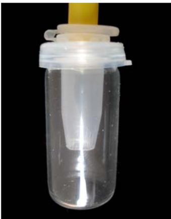
Abbildung 4.15: Rollrandglas mit vorbereitetem Reaktionsgefäß und Plastikröhrchen
