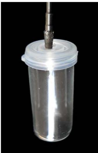
Abbildung 4.13: Beispielhaft ist die Bohrung in den PE-Schnappdeckel des Rollrandglases dargestellt.
