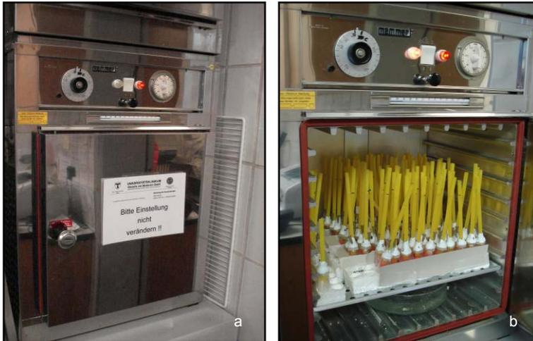
Abbildung 4.19: Wärmeschrank mit 110 Versuchsaufbauten
