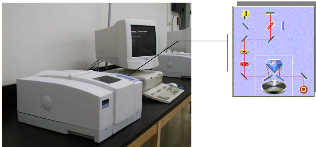
Abb. 2.14 Aufnahme von Perkin Elmer FTIR Spektrum one ATR; Messprinzip
