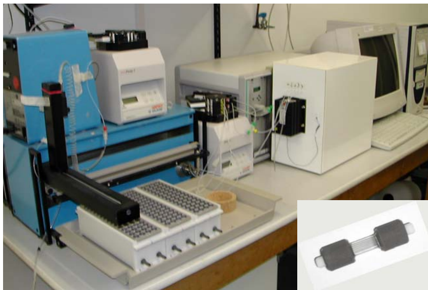
Abb. 2.8 Aufnahme der Durchflussanalysenanlage [FIA] , (Autosampler mit Racks, Isolierbox enthält den Enzymreaktor [unten rechts], PC, 2 Pumpen)
