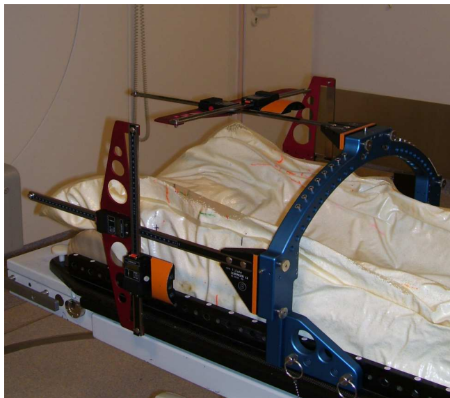
Abbildung 3: Aufbau des stereotaktischen Rahmens mit externem Koordinatensystem zur Gewährleistung der Übereinstimmung des berechneten und realen Isozentrums.
