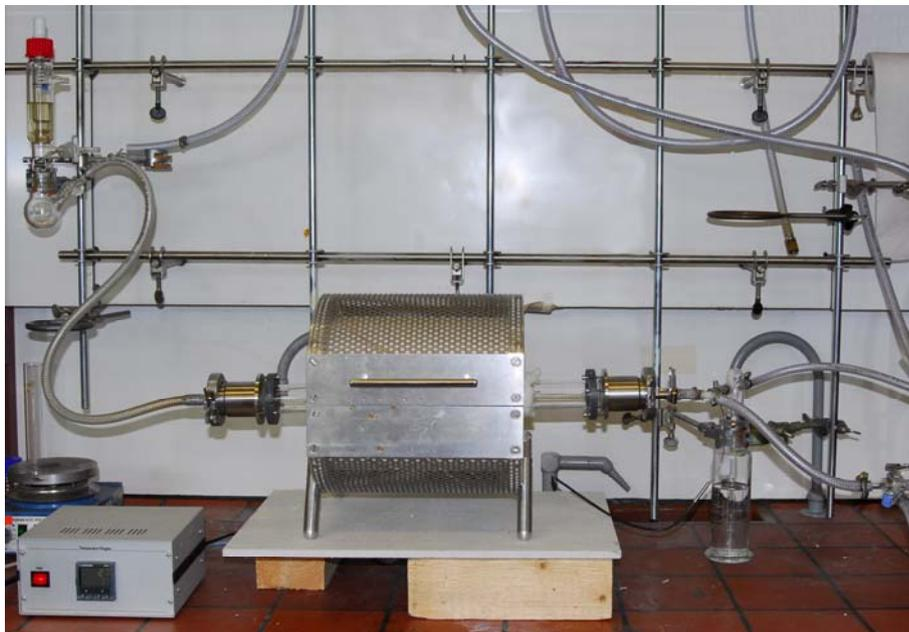
**Abb. 4.1 Aufbau des Röhrenofens.**
