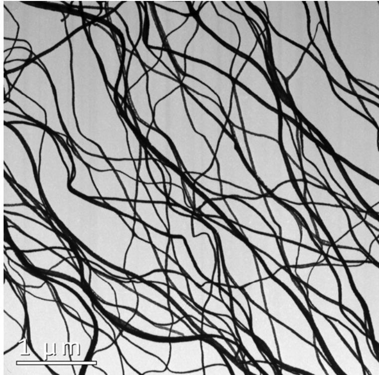
**Abb. 3.48** Cobaltdrähte reduziert aus PVB /  $\text{Co}(\text{NO}_3)_2$  - Kompositfasern.
