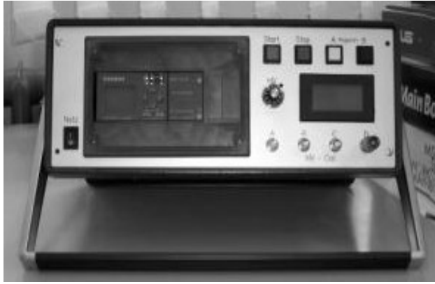
Abbildung 46: Eigenbau des Hochspannungsnetzgerätes.
