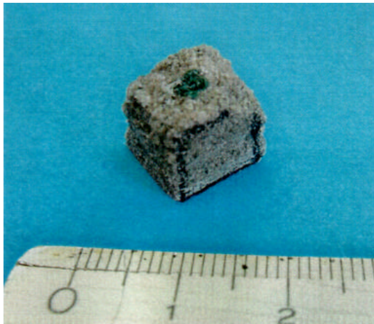
Abb. 77: Für die CT-Messung verwendete Probe (Brg 3 Kern A; 0,13 m; Plug 010).
