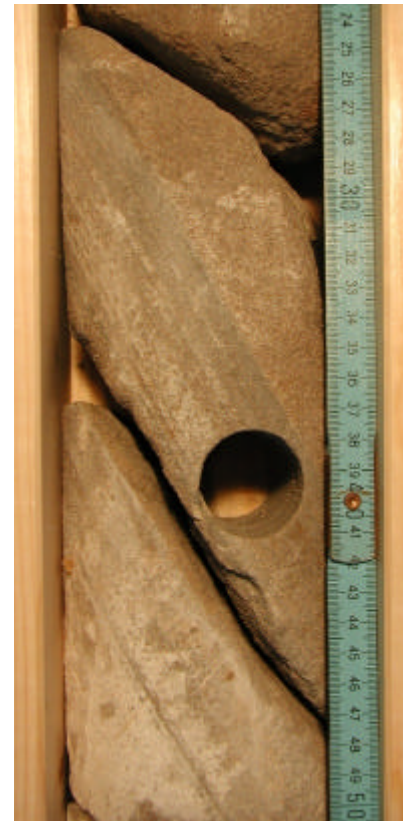
Abb. 18: In sehr mürben Mittelsandstein eingeschaltete Lage aus Feinsand.
