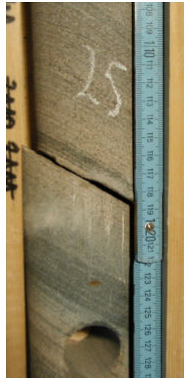
Abb. 16: Dicht laminiertes Silt- bis Feinsandstein, wirkt als Permeabilitätsbarriere. Darüber Mittelsandstein, häufig mit Tonklasten.
