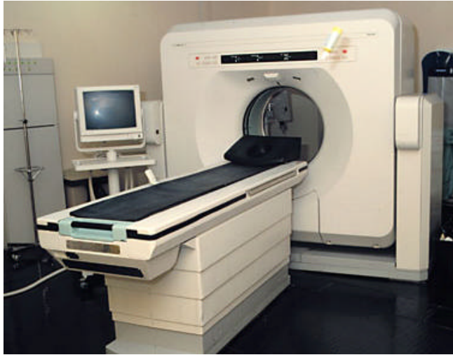
Abb. 72: Computertomograph im Krankenhaus. Röntgenquelle und Detektor rotieren um das Untersuchungsobjekt.
