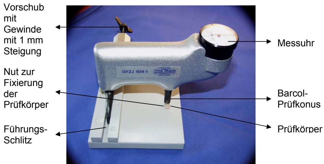
Abb. 9: Barcol-Härtemessgerät mit Messapparatur
