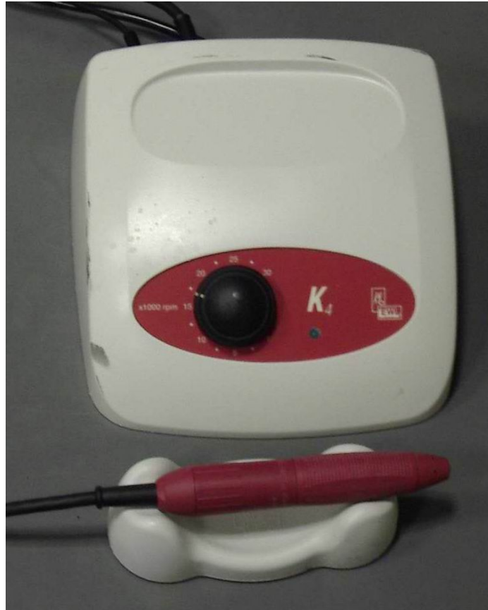
Abbildung 3: Tisch-Steuergerät 4954 und K4 Handstück 4914 der Firma Kavo, Germany.
