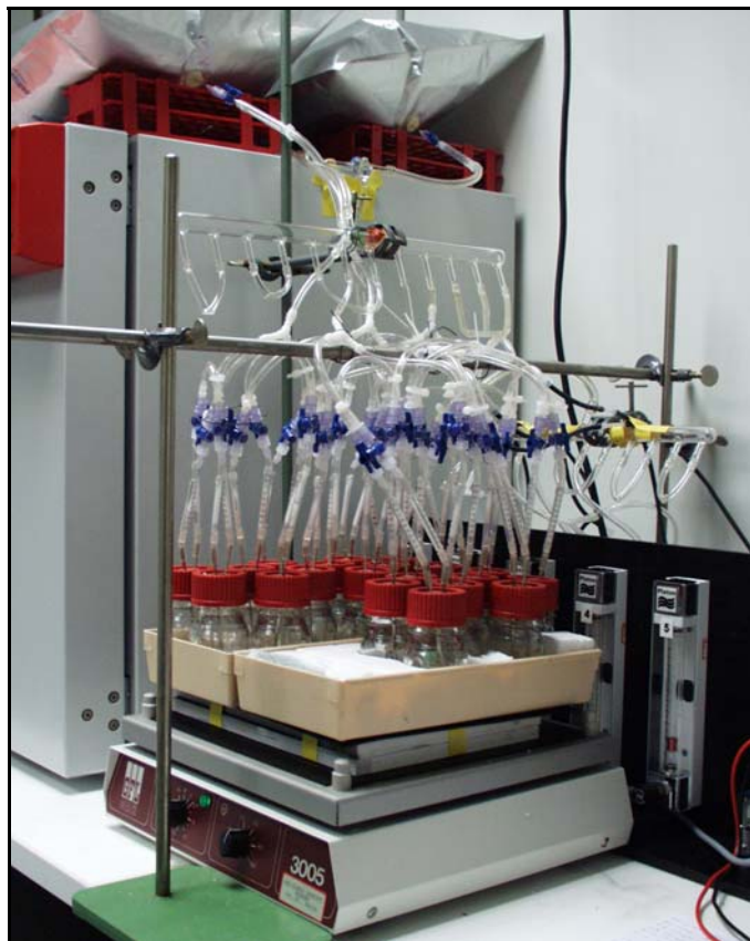
Abbildung 2.1: Aufbau zur Inkubation methanotropher Bakterien unter niedrigen Methan-Mischungsverhältnissen. Die gewünschte Methankonzentration wurde in den Gasbeuteln eingestellt. Über Membranpumpen, die über eine Zeitschaltuhr regelmäßig aktiviert wurden, wurde die Gasphase der einzelnen Ansätze ausgetauscht. Der Gasfluss wurde über Durchflussmesser kontrolliert. Der Gasstrom wurde nach Durchströmen der Ansätze gebündelt und in die Beutel zurückgeführt.
